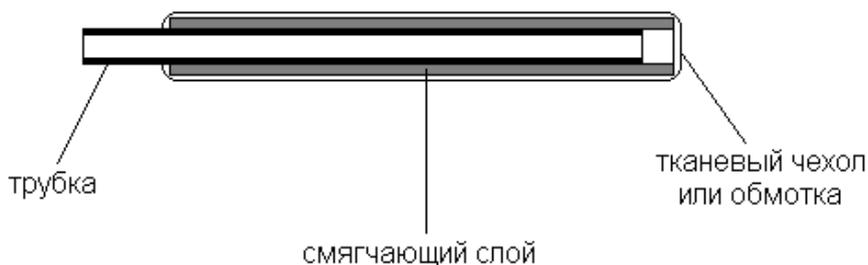
Легкое тренировочное оружие представляет собой пластмассовую (полиэтилен, полипропилен, полихлорвинил) трубку длиной примерно 700мм и диаметром примерно 30мм. Трубка покрыта снаружи смягчающим слоем в 10мм
